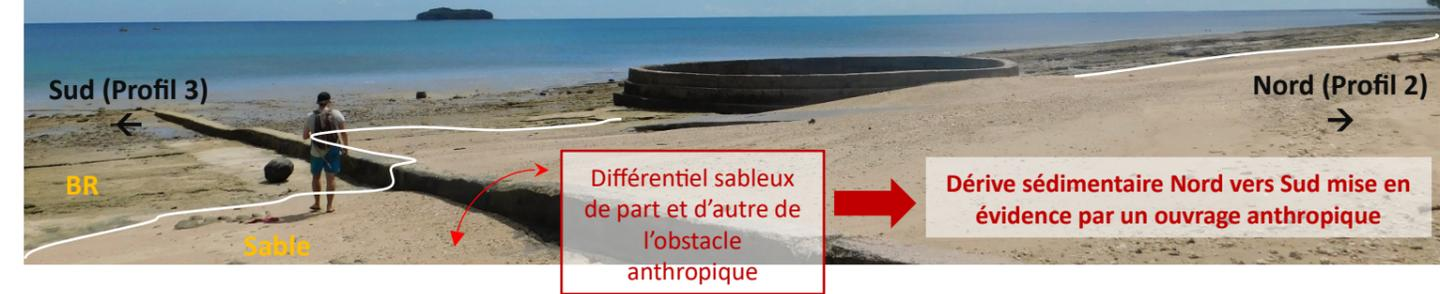
**Phénomène d’érosion localisé au niveau d’un point dur dans le HDP**
